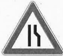
Одностороннє (з правого боку) звуження дороги
